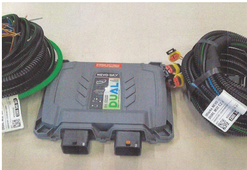
Obr. 2 Riadiaca jednotka NEVO-SKY typ DUAL pre vozidlá s kombinovaným vstrekovaním benzínu.
