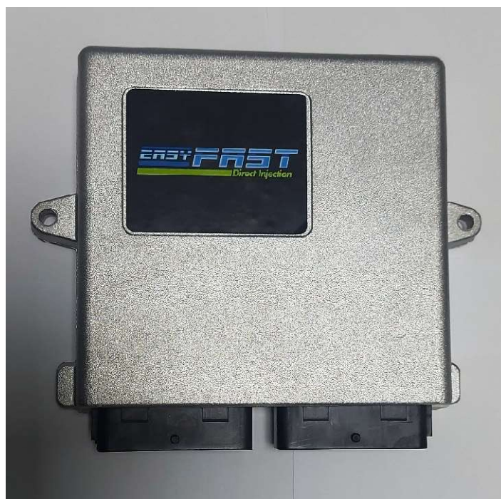
Obr. 2a Riadiaca jednotka EASYFAST Direct Injection plynového zariadenia LOVATO, starší typ.
