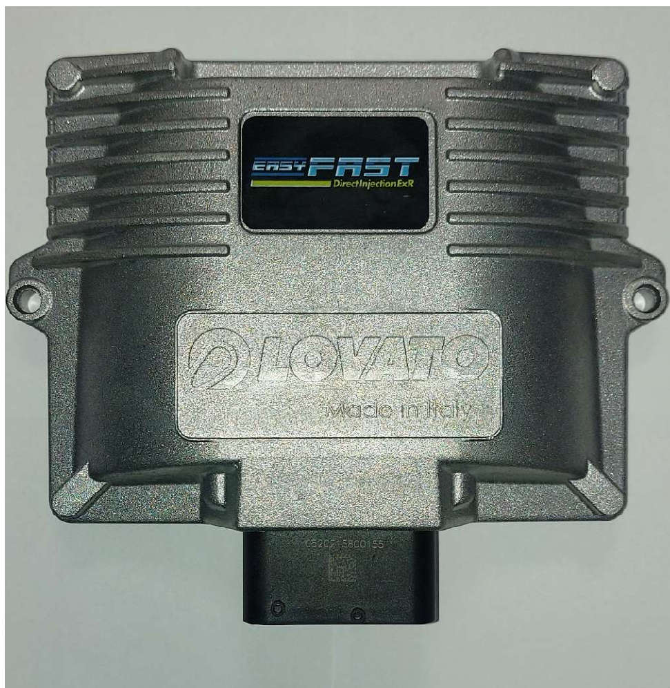
Obr. 1a Riadiaca jednotka EASYFAST Direct Injection plynového zariadenia LOVATO, novší typ.
