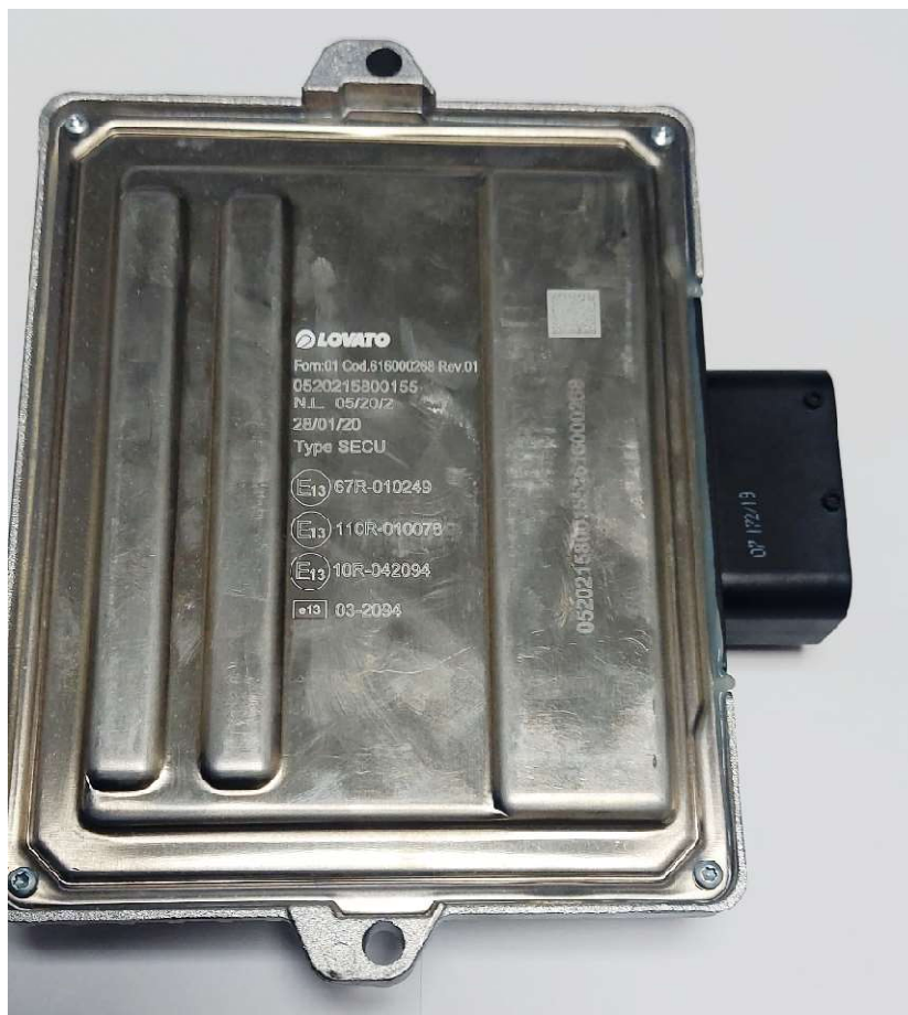
Obr. 1b Zadná strana riadiacej jednotky EASYFAST Direct Injection plynového zariadenia LOVATO, novší typ.
