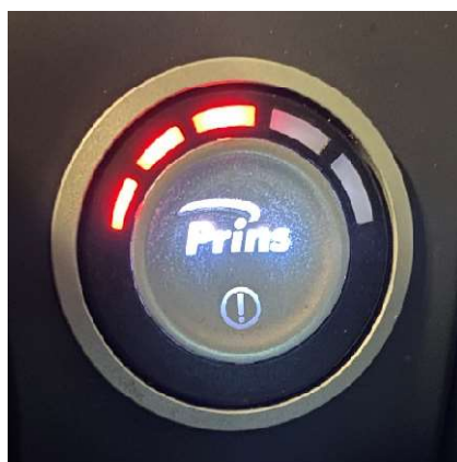
Obr. 1. Detail prepínača palív s rozsvieteným znakom PRINS
