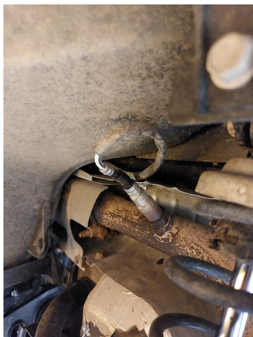
Obr. 2. Umiestnenie lambda sondy vo výfukovom vyústení vozidla CF MOTO.
