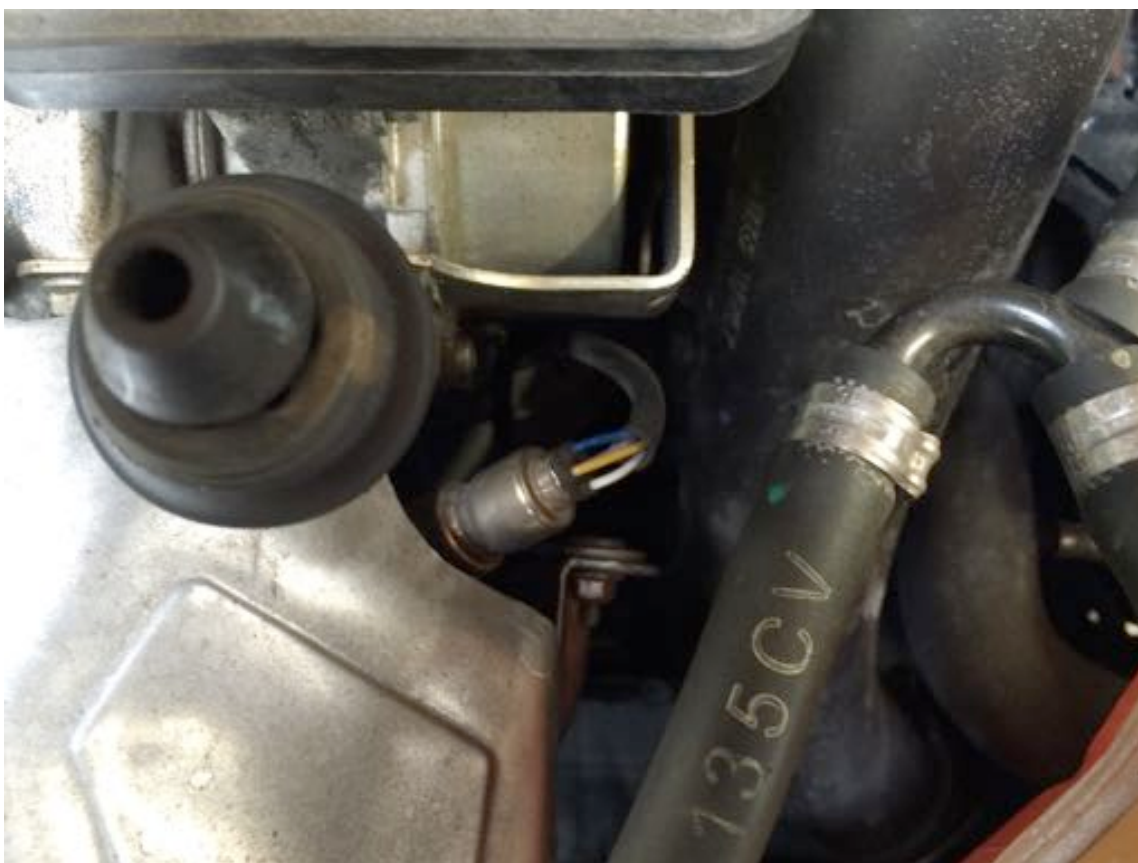
Detail lambda sondy vo vozidle FIAT PUNTO.
